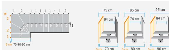
La ringhiera supplementare esterna **Magia90.Xtra**, composta da 4 colonnine, 5 tubi paralleli, corrimano e fissaggi, viene utilizzata come protezione se il lato esterno della scala è lontano dal muro. La ringhiera esterna allarga la misura della scala di 5 cm.
